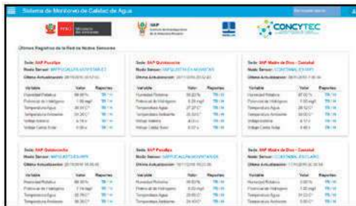
Imagen 139: Interfaz principal del sistema de monitoreo.
