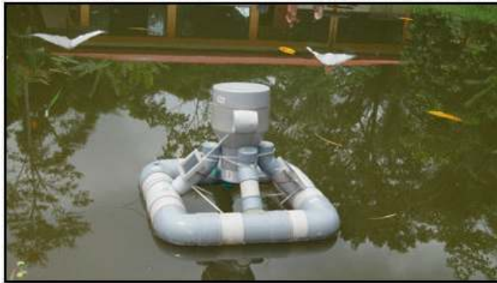
Imagen 133: Nodo sensor transmitiendo datos en Loreto.
