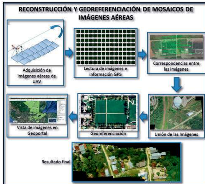
Imagen 150: Proceso de reconstrucción y georeferenciación de mosaicos de imágenes aéreas, fuente informe de proyecto.
