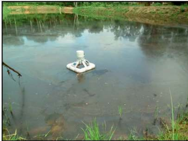
Imagen 137: Nodo sensor transmitiendo datos en Pto. Maldonado.
