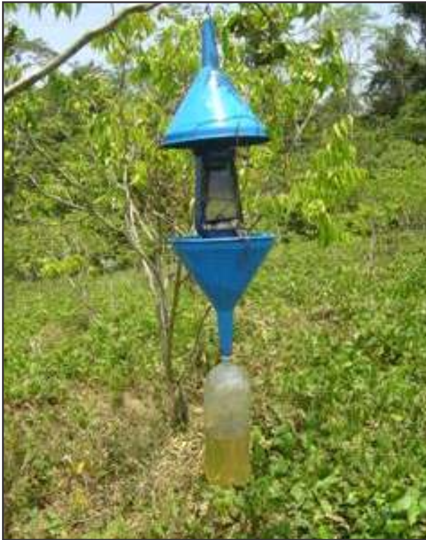
Trampa de luz para captura de adultos (polillas) de la oruga zebra y de la oruga roja
