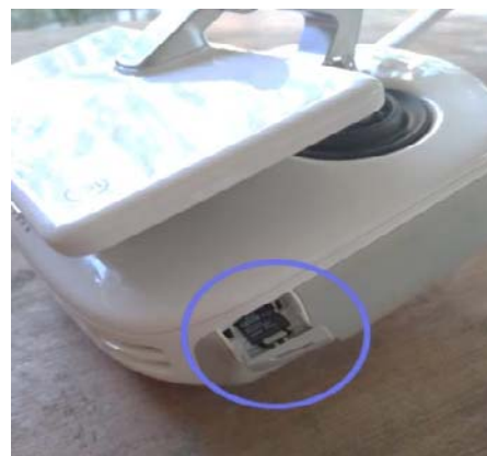
Figura 23. Inserción de memoria microSD en el control remoto.
