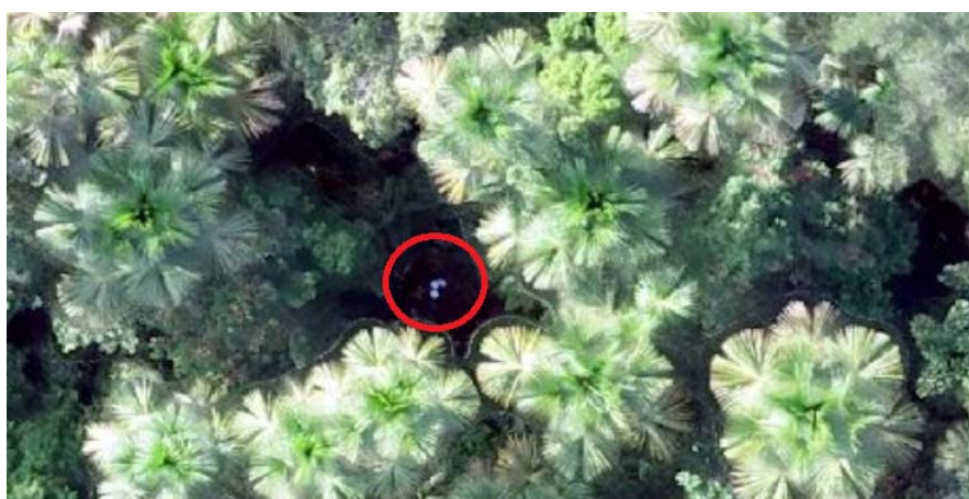
Figura 1. GCP (dentro de circunferencia color rojo) ubicado en claro del bosque.
