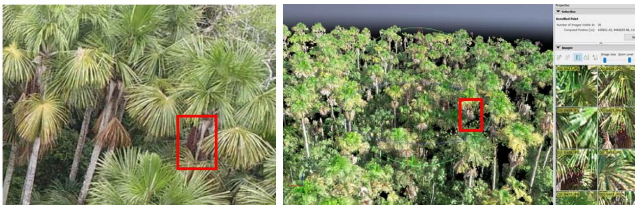
Figura 34. a) Imagen oblicuas capturadas con PH4 Pro para la detección de frutos de aguaje. b) Reconstrucción 3D de un aguajal, en donde se puede observar a los frutos de aguaje.
