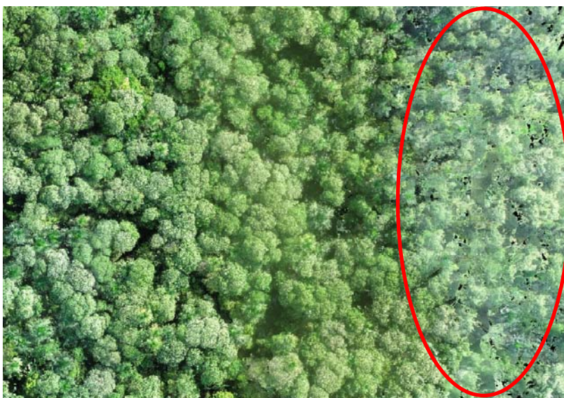
Figura 5. Parte de un mosaico obtenido usando el software Pix4D mapper. La parte señalada en rojo presenta “agujeros” negros y zonas borrosas debido a la falta de imágenes con suficiente traslape para poder reconstruir el mosaico.
