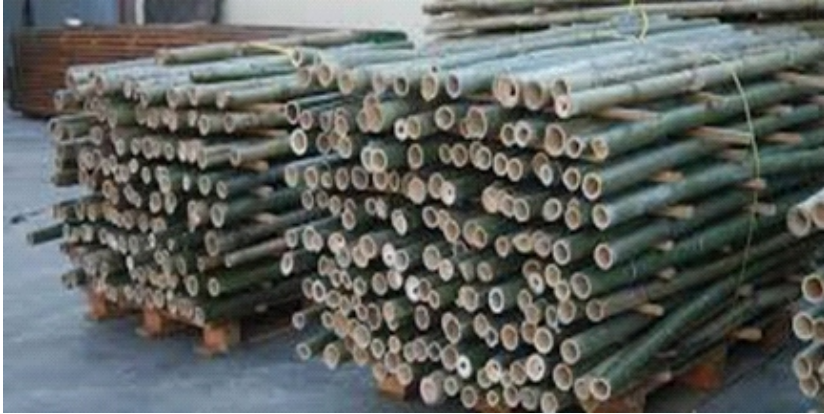
Foto 9. Almacenamiento de culmos de bambú posterior al secado
