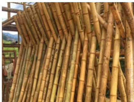
Foto 9. Secado al aire en posición de tijeras o caballetes de culmos de bambú 1
